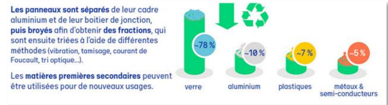
Figure 5 : Procédure de recyclage des panneaux (source : SOREN)
